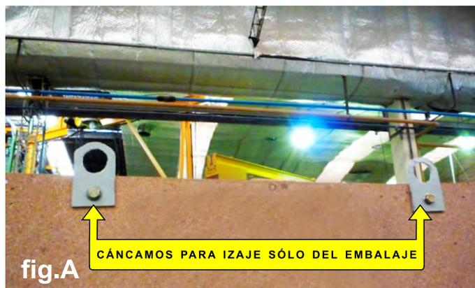
Estos cáncamos son sólo para el izaje del embalaje y no soportan el peso de la máquina.
