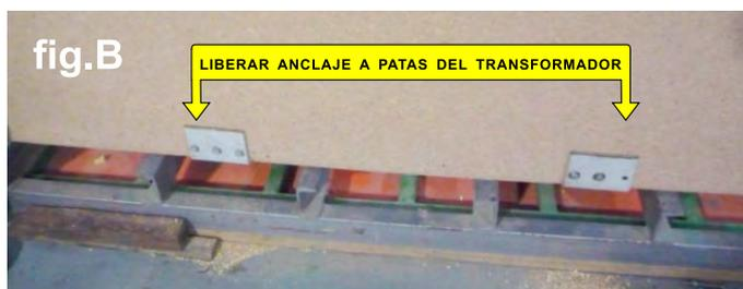
Libere el anclaje de los paneles laterales a las patas del transformador para evitar complicaciones al momento de desembalar.
