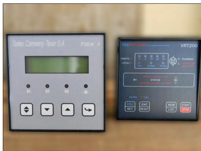
**Fig. 24** Central de termométrica TSX 1 y Central VRT 200 para comando de ventilación forzada del transformador.
